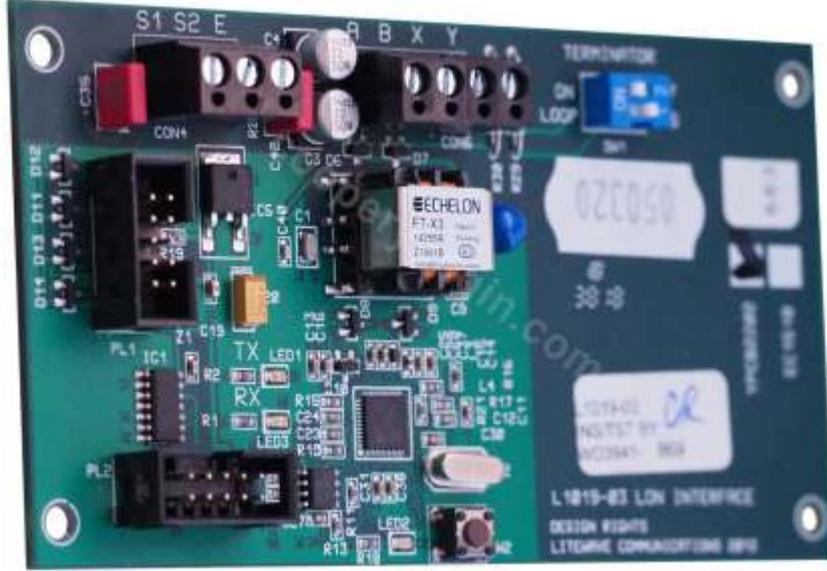
Df6000Netkit, DF61Netkit Network kartı paneller arası LONWorks protokolü ile iki sinyal kablosunun ring döngüsü yapılmasıyla çalışmaktadır. Paneller, tekrarlama panelleri, bilgisayar kontrol yazılımları ile kullanılan çevirici modüllerin haberleşmesi için kullanılmaktadır.
